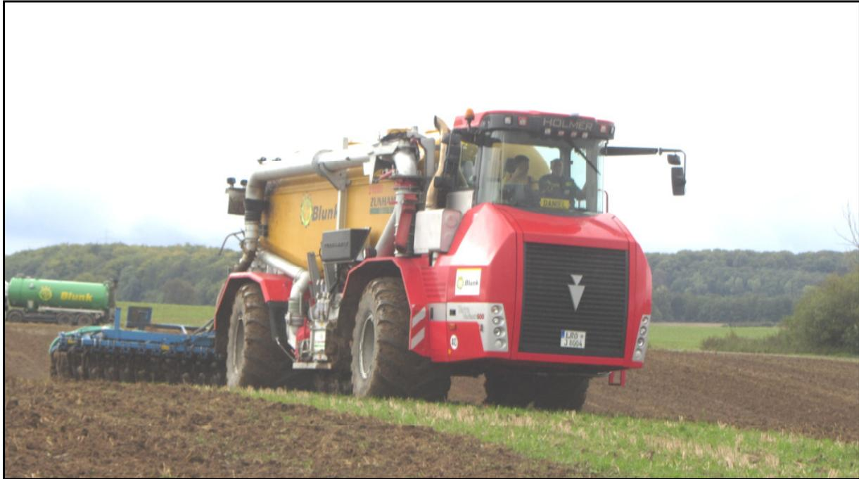
**Abbildung 6:** Ausbringung der Gülle mittels Gülleinjektoren (Foto zur Verfügung gestellt durch Herrn Thomas Schulz)
